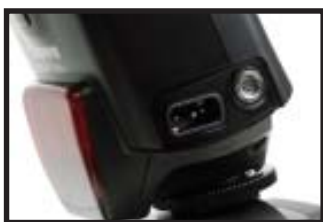
เซนเซอร์รับสัญญาณ Wireless ช่องต่อพ่วงกับ Battery Pack และ ตัวยึดกับ Bracket
