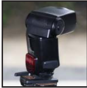
■ ลักษณะการหมุนหัวแฟลชเพื่อหันตัวรับสัญญาณของ slave ให้สามารถรับสัญญาณจาก master
