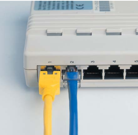
ได้ทุกช่อง : คุณสามารถต่อสายเข้ากับพอร์ตไหนของ Hub ก็ได้หมายเลขนี้ไว้เพื่อเป็นสัญลักษณ์เท่านั้นเอง
