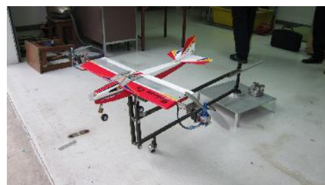
รูปที่ 3 แสดงการติดตั้งแบบจำลองอากาศยานกับแท่นทดสอบ
