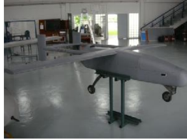
รูปที่ 1 อากาศยานต้นแบบ PUKSIN Pro MKII UAV
