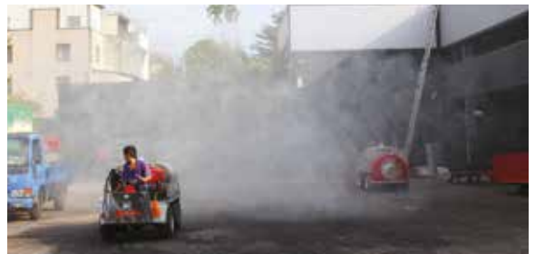
จุดเด่นในการใช้รถฟ่นสารเคมีแบบแอร์บลาสท์ คือ ฟ่นละเอียดเป็นละอองกำจัดเพลี้ยและเชื้อโรคจากบนต้นครอบคลุมถึงพื้นดิน
