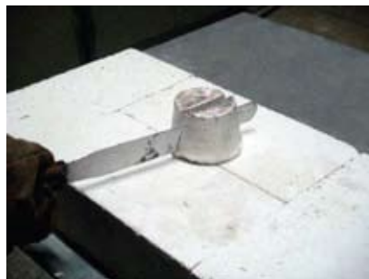
รูปที่ 4 สมบัติของแท่งอะลูมิเนียมกึ่งของแข็งที่ตัดด้วยมือโดยใช้แรงเพียงเล็กน้อยก็ขึ้นรูปได้
