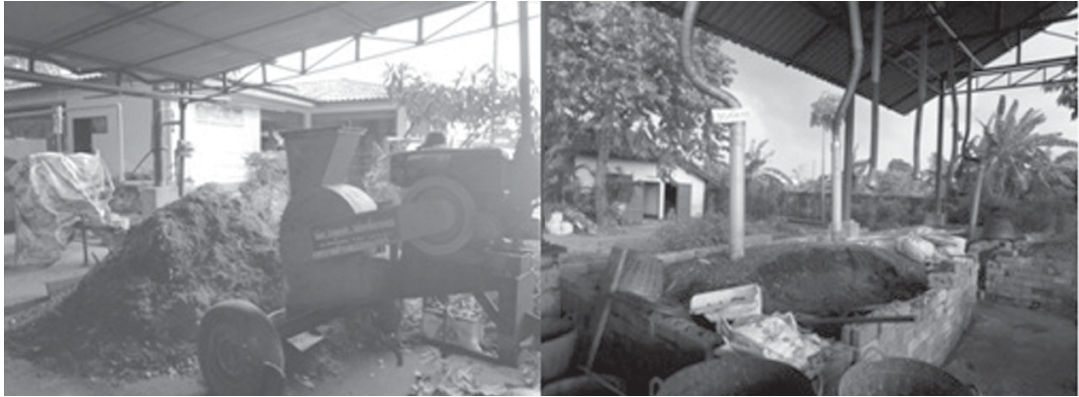
เศษกิ่งไม้ที่เทศบาลตำบลแกลง จ.ระยอง ถูกนำเข้าเครื่องบดย่อยเพื่อนำไปทำปุ๋ยหมักร่วมกับเศษใบไม้และเศษอาหาร
