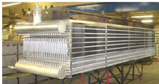
รูปที่ 5.34 รูปร่างภายนอกและการเรียงตัวของชุดท่อของเครื่องระเหยแบบแห้ง
